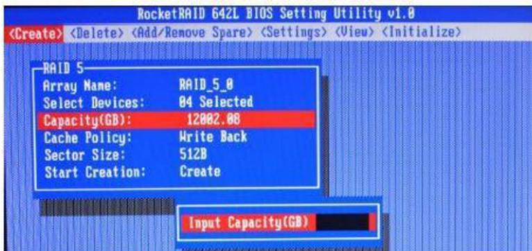
注意: 可以使用同一组硬盘驱动器创建多个阵列。“容量”选项允许您留出用于创建另一个阵列、设置为备用磁盘或分区为单个磁盘(由操作系统操作)的磁盘空间。
